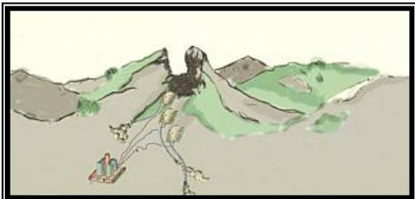
Mit mehreren Fräßmaschinen, die versetzt fahren, wird das zersprengte Gestein zerkleinert und nach hinten ausgeblasen.
